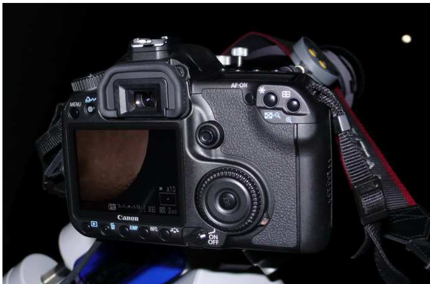
La Lune est visualisée en live view sur l'écran du 40D avec le zoom x10. La couleur et la luminosité de la Lune sont faussées par le flash utilisé pour cette photo
